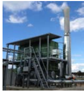
可再生式后续燃烧 (RNV), 3.300 Nm³/h
