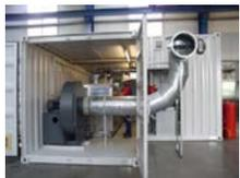
Adsorptionsanlage mit KNV, 6.000 Nm<sup>3</sup>/h
