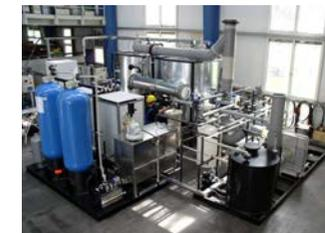
Regenerierbares Aktivkohlefilter zur Lösemittelrückgewinnung
